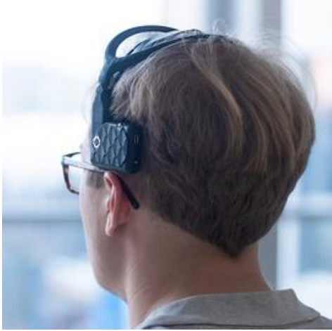
Viselhető agy-gép interfész (kiváltott agyi jelek, elképzelt mozgások)
